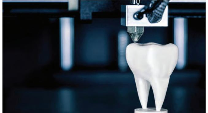
Figure 3 : dent imprimée en PEEK
